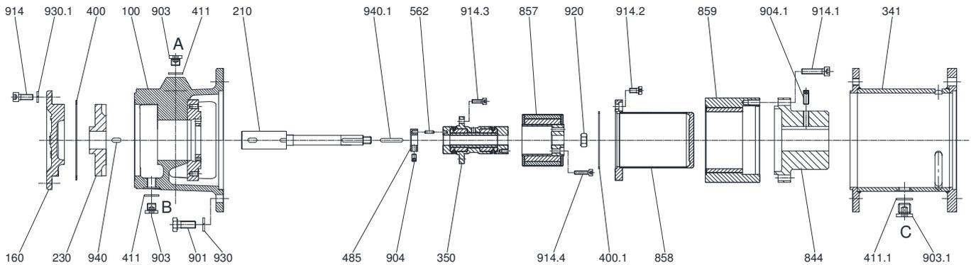
A: 2 Verschlussstopfen G1/8 für Entlüftung und Manometeranschluss
